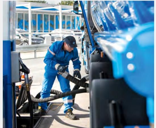
Beim Befüllen der Lagertanks an der Tankstelle werden die Kohlenwasserstoffdämpfe über einen separaten Schlauch in den Tankwagen zurückgeführt.
