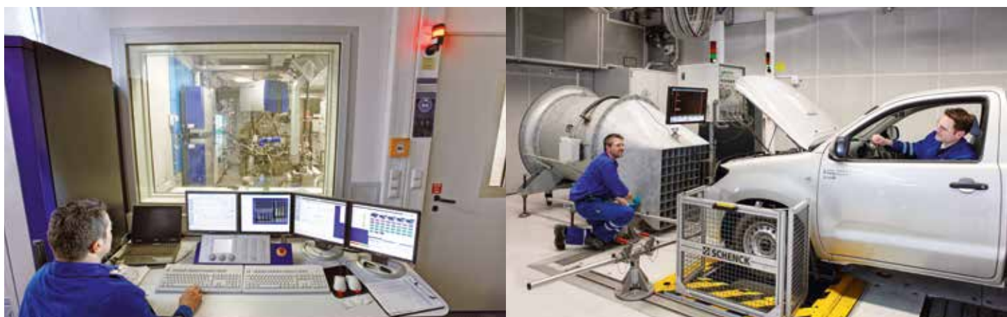
An den Prüfständen der BP/Aral Kraftstoffforschung prüfen Techniker, wie wirksam Benzin oder Diesel im Motor verbrennen.
