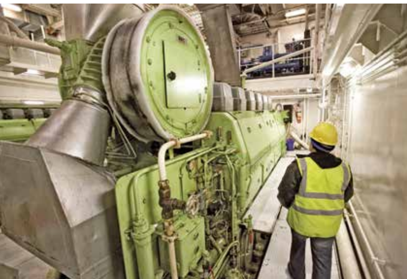
Um die großen Schiffsmotoren verlaufen Etagen, damit alle Bereiche eingesehen werden können.
